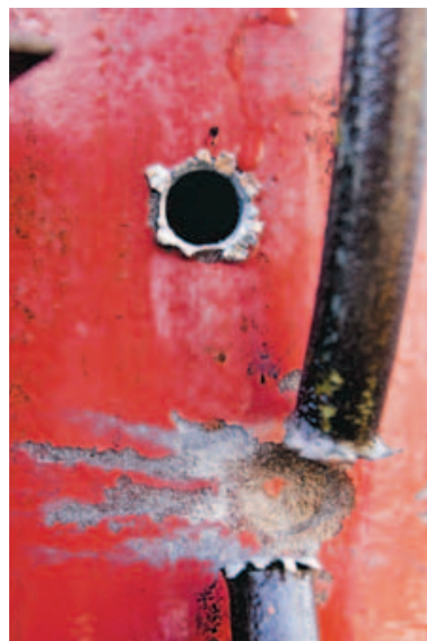
Två skott krävdes för att få hål på gastuben. Övertrycket i tuben innebar en explosionrisk.
